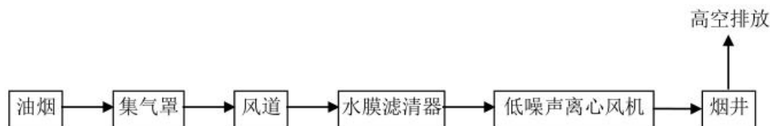
图 9.3-1 车辆段食堂油烟废气治理措施工艺流程图
