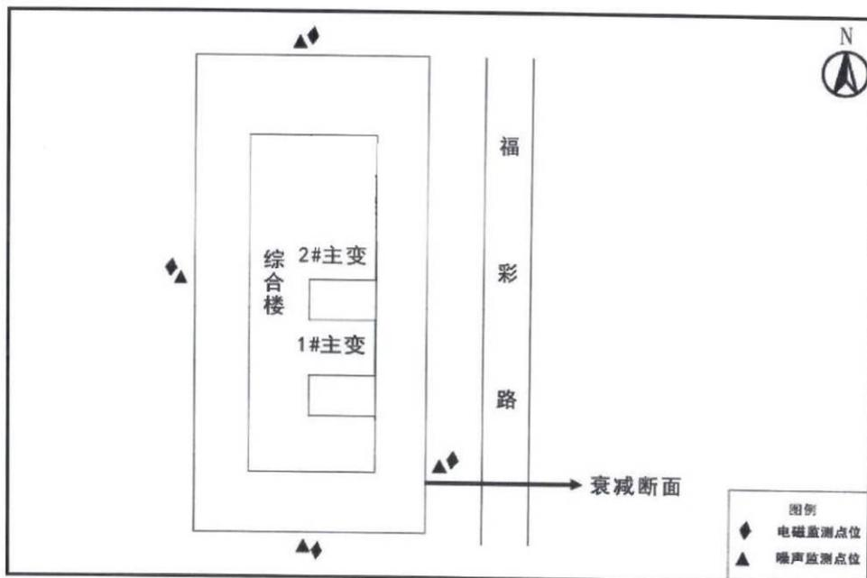
图 6.4-1 110kV 黄家庵变电站监测布点图
