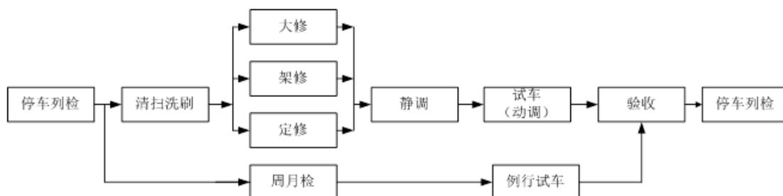
图 2.1-3 列车检修工艺流程图
