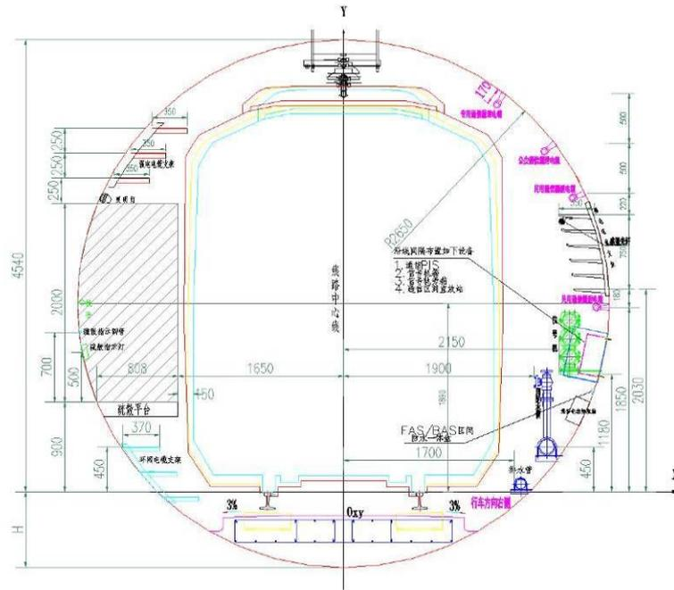
图 2.1-14 盾构隧道横断面图
