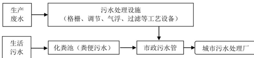
图 7.4-2 车辆段、停车场污水处理措施示意图
