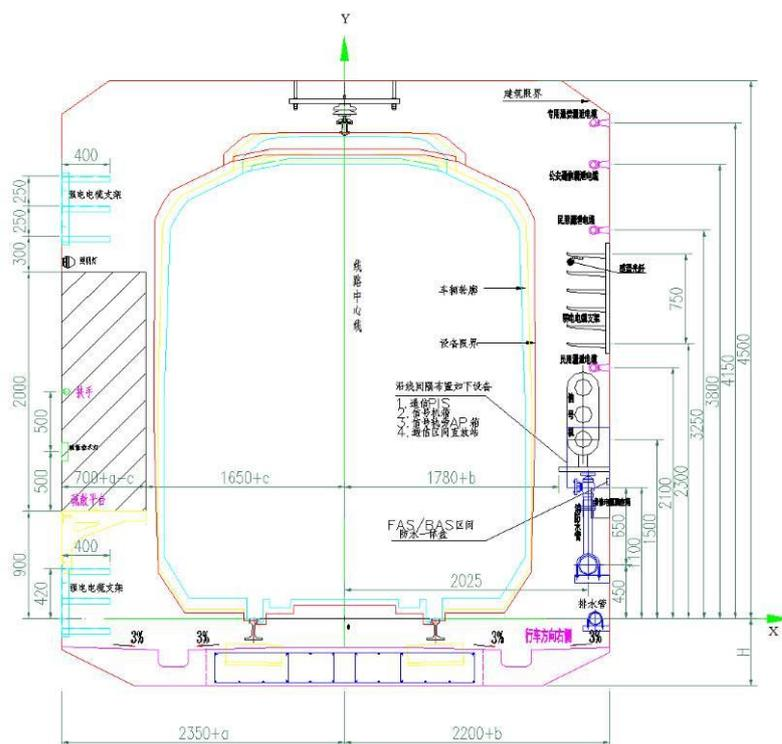
图 2.1-15 矩形隧道横断面图
