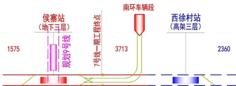
图 2.1-7 南环车辆段出入段线平面示意图
