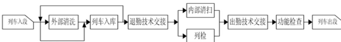
图 2.1-2 列车运用列检工艺流程图
