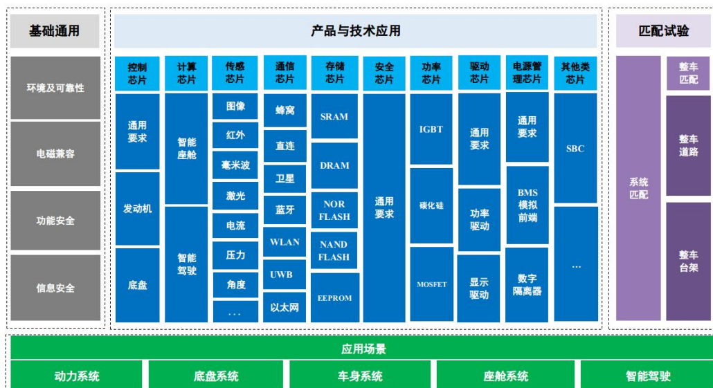
图 1 汽车芯片标准体系技术结构图
